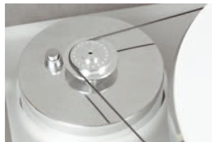
Silnik wstawiamy w wycięcie podstawy, lecz w taki sposób, żeby jej nie dotykał.
