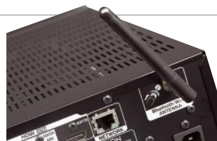
Tylko w Denonie znajdziemy wbudowane układy Wi-Fi i Bluetooth oraz dwie zewnętrzne anteny.
