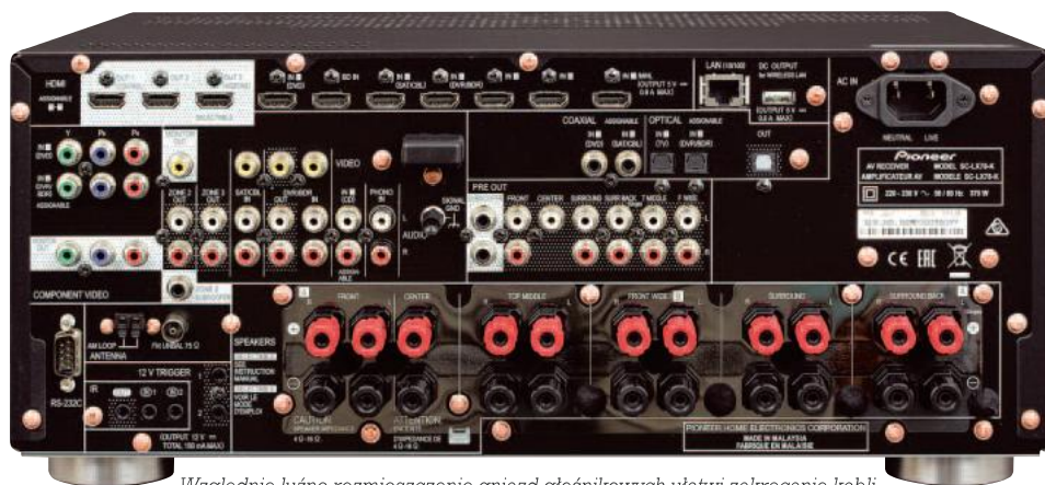
Względnie luźne rozmieszczenie gniazd głośnikowych ułatwi zakręcanie kabli.
