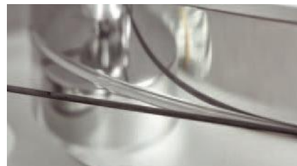
Pasek ma okrągły przekrój i wpasowuje się w wyfrezowanie w talerzu.
