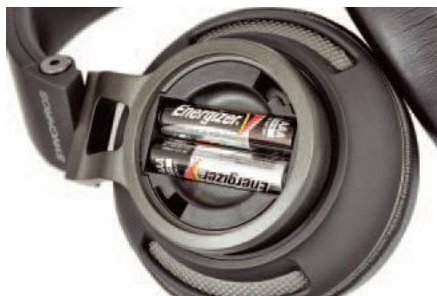
Miejsce dla dwóch baterii AAA wygospodarowano pod „kapslem” jednej z muszli - ogniwa zasilają system LiveStage.
