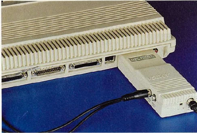
Drugi kabel włączamy jednym końcem do modulatora...
