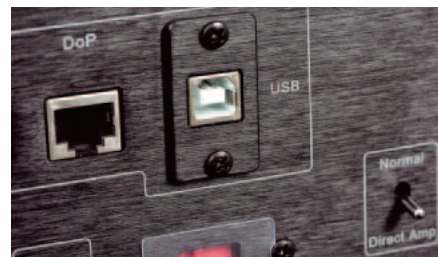
Asynchroniczne wejście USB oficjalnie przyjmuje sygnały 24 bity/192 kHz.
