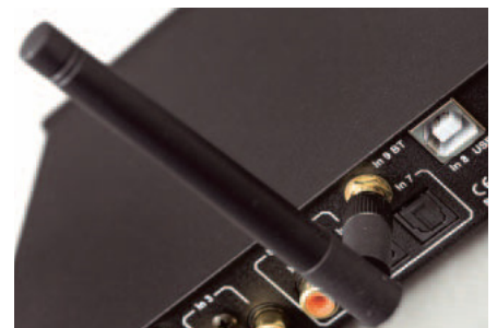
MAiA wyróżnia się zewnętrzną anteną dla układów Bluetooth oraz wejściem USB akceptującym sygnały 24/192.
