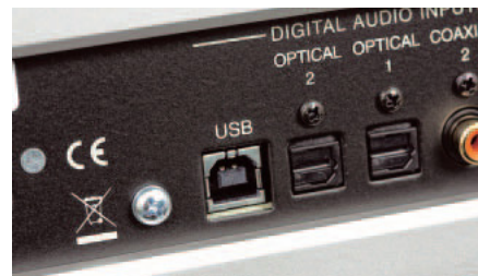
Wejście USB w najlepszej, asynchronicznej wersji obsługuje sygnały 24/192.
