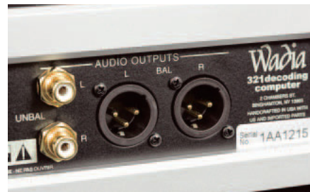
Gniazda RCA i XLR są zasilane równocześnie i sprzężone z układem regulacji napięcia wyjściowego.
