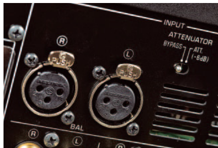
Gniazdo XLR wyposażono w przełączniki tłumienia oraz polaryzacji.
