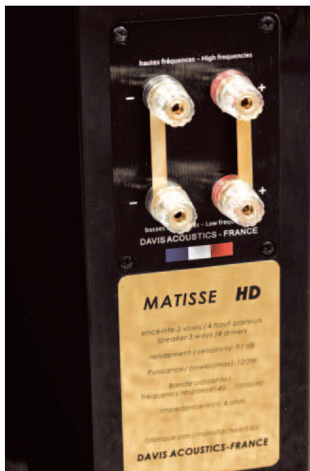
Solidne zaciski w komplecie do bi-wiringu, ale i z przyzwrotnymi zworami, które pewnie częściej będą w użyciu niż podwójne okablowanie.
