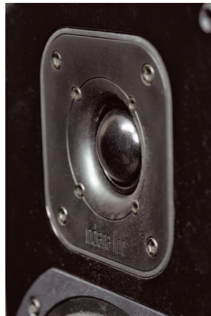
Głośnik wysokotonowy wygląda zwyczajnie – jednocalowa tekstylna kopułka – ale przygotowano specjalne mocowanie, siedzi w „gnieździe” zatrzymującym wibracje obudowy (jego krawędź widać dookoła frontu).
