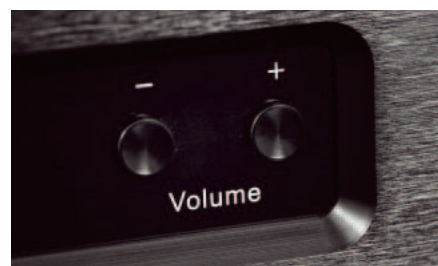
Cały układ regulacji głośności można odłączyć, gdy przetwornik będzie pracował z zewnętrznym przedwzmacniaczem.
