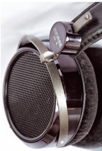
Budowa mechaniczna HiFiMAN-ów jest solidna i klasyczna. To słuchawki otwarte, z metalową maskownicą zakrywającą zewnętrzną stronę membrany.
