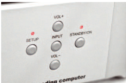
Klasyczny dla Wadii układ „kursorów”, dolny i górny służą do regulacji poziomu na wyjściach.
