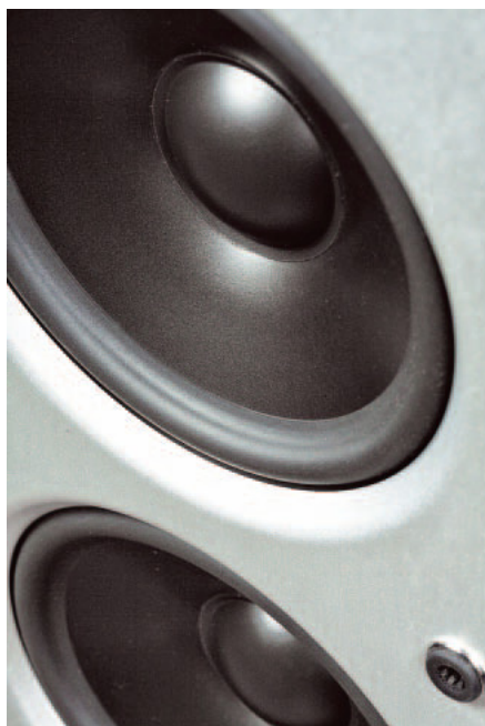
Dwie „15” z celulozowymi membranami pracują w całym zakresie nisko-średniotonowym.
