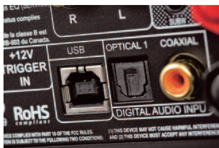
NAD nie ma interfejsu sieciowego, ale port USB pozwala na podłączenie komputera i przesłanie sygnałów 24 bity/96 kHz.
