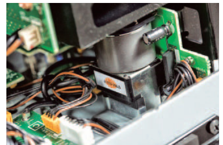
Potencjometr głośności pełni tylko rolę czujnika położenia...
