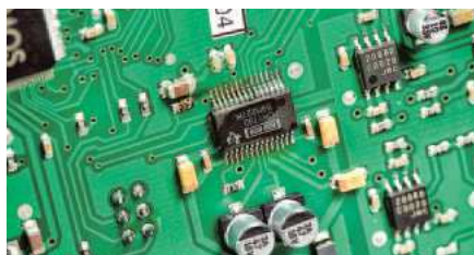
Burr Brown PCM1792 – już klasyka, ale akceptująca sygnał PCM do 24 bitów i 192 kHz i DSD.
