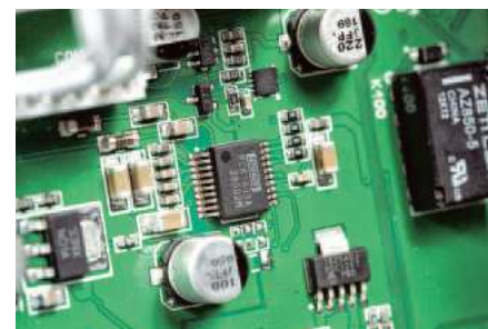
PRE60 wyposażono w wyjście cyfrowe. Żeby można było zeń wysłać sygnał z dowolnego wejścia, także analogowego, sięgnięto po niedrogi przetwornik analogowo-cyfrowy Burr Brown PCM1803. Parametry nie będą najwyższe, ale to funkcja marginalna.
