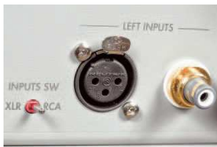
Aktywne wejście wybieramy za pomocą małego hebelka, słusznie schowanego z tyłu – tego wyboru dokonujemy raz na dłuższy czas, a nie na co dzień.
