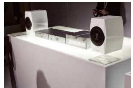
Drugi z systemów stereo – C700 – ze zintegrowanym wzmacniaczem, procesorem i odtwarzaczem oraz parą dwudrożnych monitorów.
