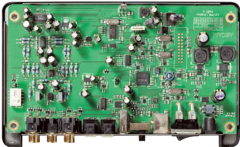
Jedna duża płytka z montażem mieszanym – powierzchniowym i w tradycyjnej technice przewlekanej.
