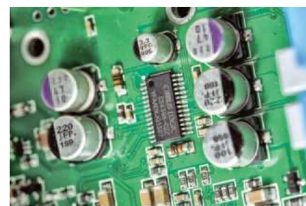
Cirrus Logic CS4398 wygląda niepozornie, ale to centrum urządzenia, przetwornik cyfrowo-analogowy.
