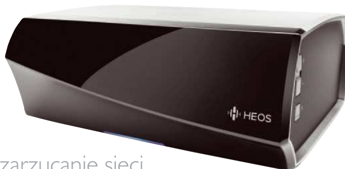
Heos Amp – źródło strumieniowe systemu Heos zintegrowane ze wzmacniaczem o mocy 2 x 100 W.
