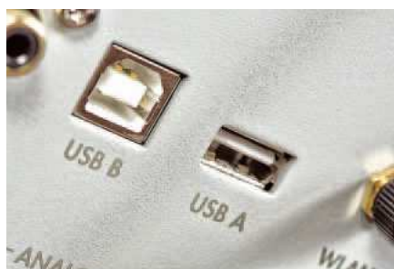
Dwa wejścia USB – jedno służy do podłączenia komputera i obsługuje takie same sygnały, jak LAN, drugie jest przeznaczone dla produktów Apple, z parametrami takimi samymi jak WLAN.
