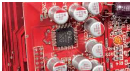
AKM AK4399 Audio4Pro 32/192 to znakomity przetwornik – przyjmuje sygnały do 32 bitów.
