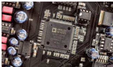
W DSP Analog Devices ADSP-2126 znajdują się filtry cyfrowe i zaawansowany upsampling.
