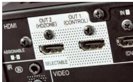
Pioneer ma dwa wyjścia HDMI z możliwością budowy prostego systemu strefowego.
