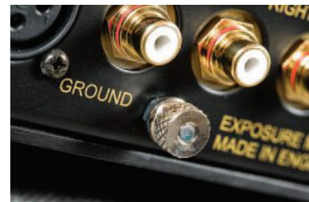
Trzpień uziemiający przyda się przy podłączeniu gramofonu, choć przedwzmacniacz jest „uzbrajany” w moduły MM lub MC dopiero na specjalne zamówienie klienta.
