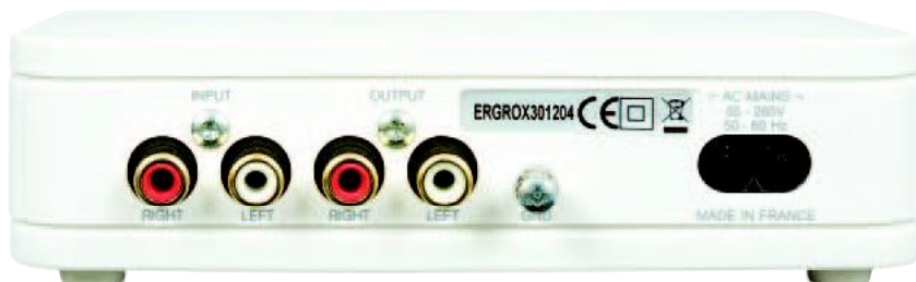
Tył przedwzmacniacza gramofonowego jest niemal dokładnie taki sam jak wzmacniacza słuchawkowego – ale tym razem przelotka jest wyjściem z urządzenia (z sygnałem liniowym), a w miejsce plastikowej zaślepki mamy śrubkę dla masy.
