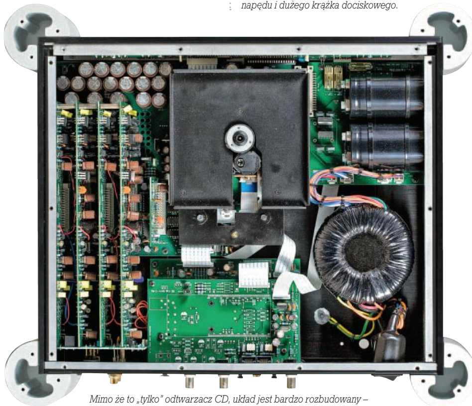
Top-loader wymagał indywidualnej konstrukcji napędu i dużego krążka dociskowego.
