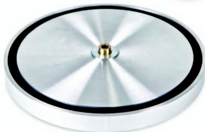
A to i sam talerz – wykonany z wąską tolerancją, idealnie wyważony, wyposażony w elementy mocowania i magnes odpychający talerz od łożyska, nacięcie wypełnione gumą, pokrycie z winylu i błyszczący brzeg wykończony diamentowym ostrzem.
