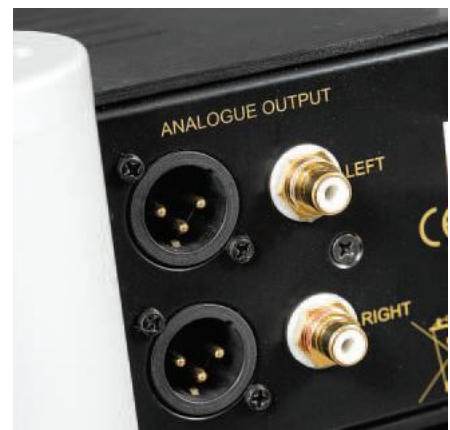
Okazałe układy zbalansowane (zaczynają się już na etapie cyfrowym) zachęcają, by wykorzystywać wyjścia XLR.
