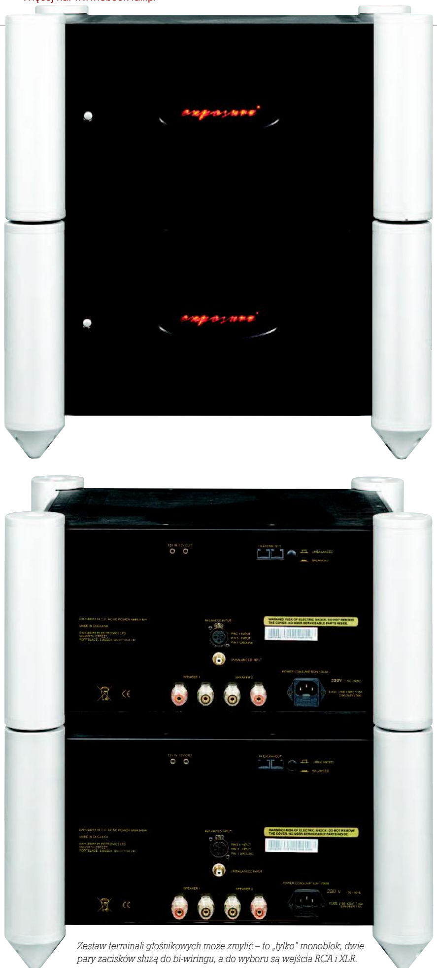
Na zewnątrz bez wyzywających radiatorów, które ukryte są w środku obudowy; za odprowadzanie ciepła odpowiadają liczne otwory wentylacyjne.
