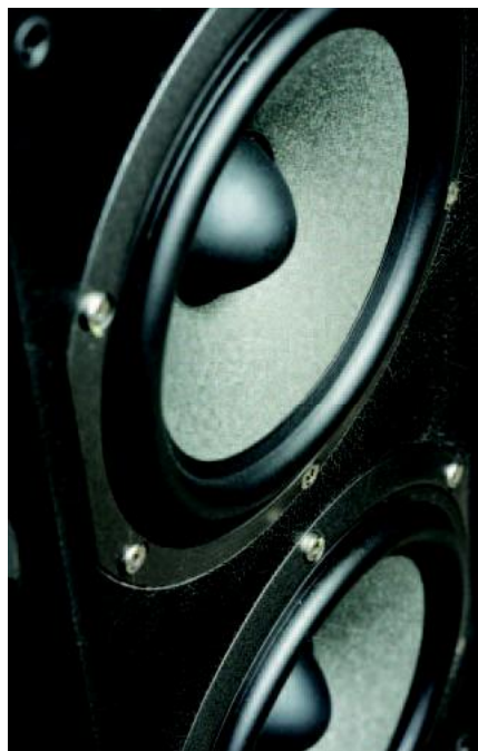
Para 5-calowych głośników pracuje wspólnie w zakresie niskotonowym, w systemie bas-refleks – tym sposobem nawet szczupła kolumnienka może zagrać całkiem zgrabnym basem.
