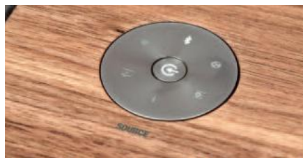
Subtelny selektor sygnału pracuje sekwencyjnie.
