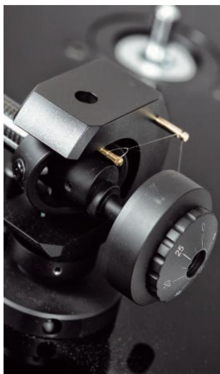
Antyskating wykonano klasycznie – to żyłka i ciężarek. Widać też, że trzpień, po którym przesuwają się przeciwwaga, jest przesunięty w dół – to drobne, ale dobre rozwiązanie.
