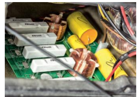
A jednak, nawet w tak aktywnej i zasilanej konstrukcji nie było się bez dużego zestawu elementów biernych, które służą do filtrowania (kształtowania charakterystyki) elektrostatu. Cieszy więc, że widać elementy dobrej jakości – kondensatory polipropylenowe i cewki powietrzne.
