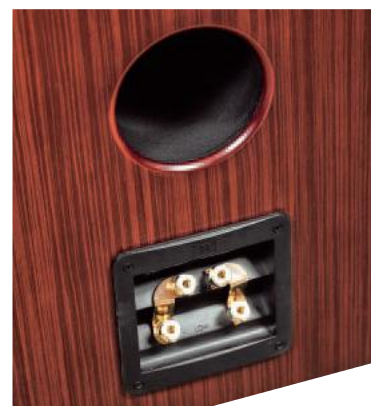
Z tyłu również użyłownie – otwór bas-refleks ma na tyle dużą średnicę, że konstruktor nie bał się turbulencji i nie uznał za konieczne wykonania wyprofilowania jego wylotu. Nie widział również potrzeby „zalecania się” do klientów luksusową oprawą gniazda przyłączeniowego – plastikowa „puszka” wygląda w tak zaawansowanej konstrukcji bardzo skromnie, i chociaż nie przypisywałbym jej wpływu na brzmienie, to na samopoczucie niektórych audiofilów – już tak.
