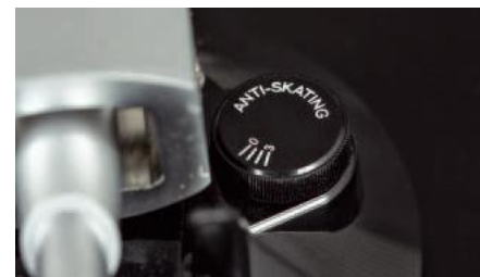
Pokrętko antiskatingu porusza się po małym wycinku, więc regulacja wymaga precyzji.
