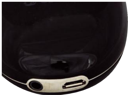
Gniazdo analogowe mini-jack – urządzenie jest zbyt małe, aby zainstalować jakiegokolwiek inne.
