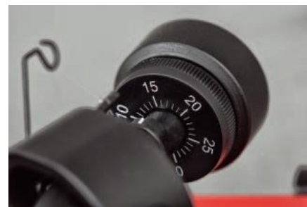
Rurka, na której porusza się przeciwwaga, jest plastikowa – tak jak w wielu budżetowych konstrukcjach.
