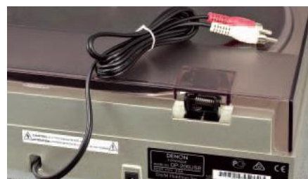
Podłączenia najprostsze z możliwych, zasilacz ścienny i zamontowany na stałe przewód sygnałowy z wtykami RCA.
