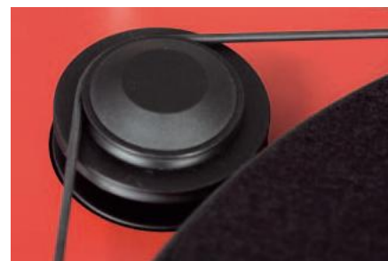
Napęd jest przenoszony z osi silnika za pomocą silikonowego paska, zmianę obrotów przeprowadza się ręcznie poprzez wybór koła pasowego.
