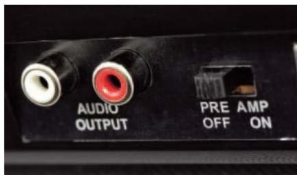
Zamiast wiszących kabli – złącza RCA. Wreszcie możemy zastosować własny interkonekt, obok wyjścia hebełek pozwalający odłączyć wbudowany przedwzmacniacz korekcyjny
