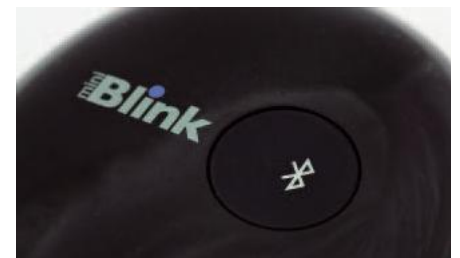
Klasyczny przycisk parujący urządzenia – rozwiązanie bez wygody automatyczności, za to z zabezpieczeniem przed niechcianymi „nadawcami”.
