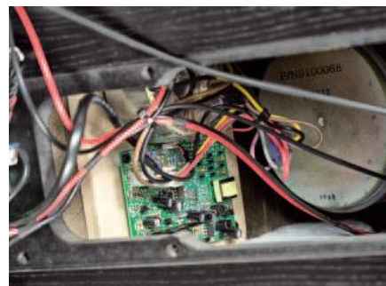
W głębi, przykręcona do dolnej ściany, chowa się jeszcze jedna mniejsza płytka – z procesorem DSP Vojtko.
