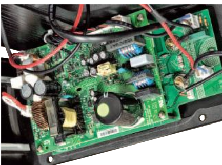
Elektronika Montisów jest bardzo rozbudowana, ponieważ zawiera zarówno zasilanie dla elektrostatu, jak też wzmacniacz i procesor DSP dla aktywnej sekcji niskotonowej. Jej większą część ulokowano na dwóch płytkach przymocowanych do odkręcanego, tylnego panelu.
