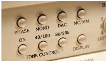
W ramach regulacji barwy dźwięku wybieramy tzw. „turnover frequency”, dla niskich tonów może to być 80 lub 100 Hz, a dla wysokich 8 lub 20 kHz.
