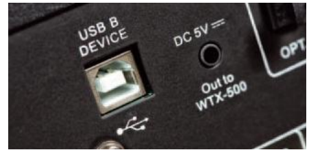
Dwa wejścia XXI wieku: wejście USB, przeznaczone do sygnału z komputera, a drugie zasilające zewnętrzny odbiornik Bluetooth. Przyjmą sygnał do 16 bitów/44,1 kHz, wyższe parametry są zarezerwowane dla wejścia RCA.
