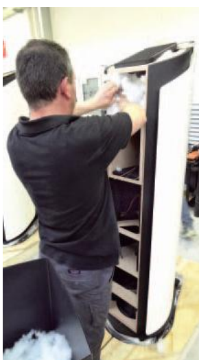
Wkładanie wytłumienia – takie klaczki można wypruć z poduszek sprzedawanych w IKEA, każdy może mieć więc w swoich kolumnach odrobinę tego, co mają najlepsze Sonusy...
