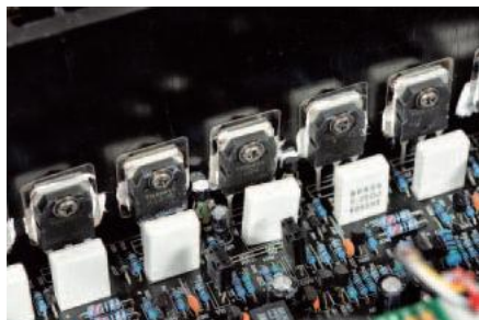
Advance ma dużą moc wyjściową, nad czym pracują tranzystory wyjściowe Toshiba 2SA1941 + 2SC5198.
