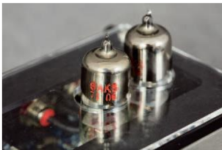
Użyte w układzie wstępnym (buforze) pentody 6AK5 były szeroko stosowane przede wszystkim w Chinach.
