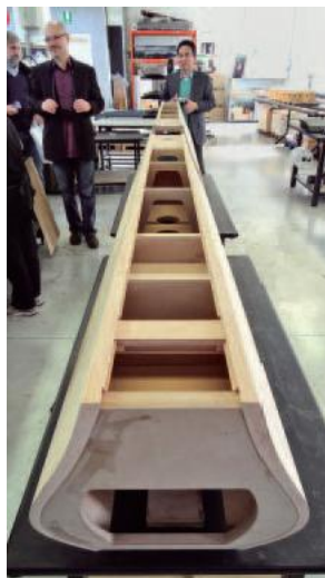
Do jakiej konstrukcji są te obudowy, nie odgadłem – może to zacząć nowego modelu? Jeżeli leżą frontem do stołu, to przekrój obudowy, pod względem akustycznym, jest wymiennym; duże zaokrąglenia za głośnikami i zwężająca się ku tyłowi komora.
