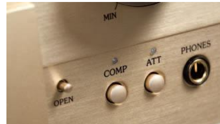
Na zewnątrz pozostawiono kilka najważniejszych manipulatorów – m.in. skokowe zmniejszenie wzmocnienia („att”) o 20 dB oraz loudness („comp”), wzmacniająca skraje pasma.
