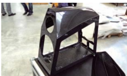
Szkielet obudowy wykonano z kilku warstw włókna węglowego nasączonego żywicą termoutwardzalną.
