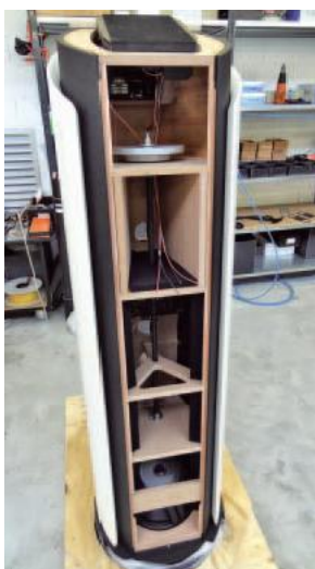
Wreszcie mogliśmy też zajrzeć do środka Aidy; na dole widać 30-cm głośniki niskotonowy.
