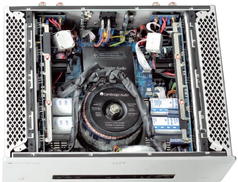
Podstawą zasilacza są dwa transformatory toroidalne – duży pośrodku, dla stopnia prądowego; mniejszy z przodu (pionowo), dla stopni wejściowych i sterującego. Końcówki mocy przykręcono bezpośrednio do radiatorów.
