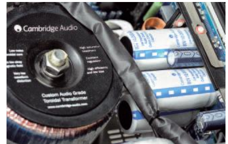
Zasilacze wraz z kondensatorami filtrującymi zamontowano na płytkach z końcówkami, tuż przy układach, których dotyczą.
