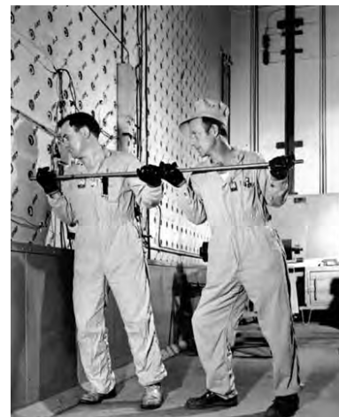
Fot. 24.3. Robotnicy wsuwają pręty paliwowe z uranem do reaktora z moderatorem grafitowym (X-10 Graphite Reactor).
