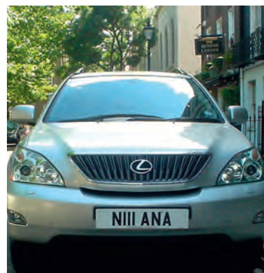
Fot. 20.1. Punkt wyjścia dla tego rozdziału: luksusowy miejski van. Przeciętny brytyjski samochód pali 7l na 100 km, co odpowiada zużyciu energii rzędu 80 kWh na 100 km. Czy można to poprawić?
