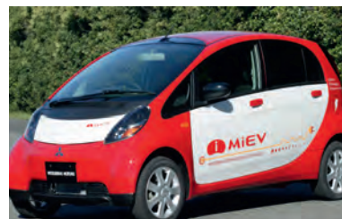
Fot. 20.38. The i-MiEV produkcji Mitsubishi. Ma silnik o mocy 47 kW, waży 1080 kg. Prędkość maksymalna 130 km/h
