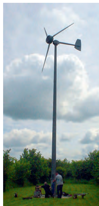
Fot. B.10. Turbina Iskra o mocy 5 kW i rednicy 5,5 m [www.iskrawind.com] w trakcie dorocznego przeglądu. Ta turbina postawiona w Hertfordshire (a nie jest to najbardziej wietrzny zakątek Wielkiej Brytanii), o wysokości 12 m, ma średnią produkcję 11 kWh dziennie. Farma wiatrowa składająca się z wiatraków o takich osiąгах, rozstawionych na kwadratach 30 m na 30 m, miałyby moc na jednostkę powierzchni rzędu 0,5 W/m 2 .
