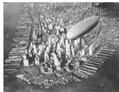
Fot. C.14. 239-metrowy USS Akron (ZRS-4) przelatujący nad Manhattanem. Ważył 100 t, zabierał 83 t ładunku. Całkowita moc silników wynosiła 3,4 MW. Przewoził 89 członków załogi i ładunek broni z prędkością 93 km/h. Służył również jako powietrzny lotniskowiec.
