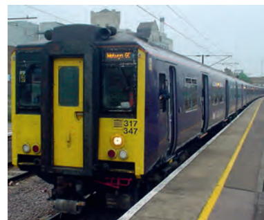
Fot. 20.4. Ten pociąg z 8 wagonami, przy prędkości maksymalnej 100 mil/h (161 km/h), zużywa 1,6 kWh energii na 100 pasażerokilometrów (przy założeniu, że wszystkie miejsca są zajęte).
