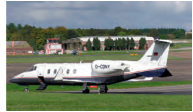
Fot. C.10. „Proszę zapiąć spinki do mankietów”. Bombardier Learjet 60XR przewożący 8 pasażerów z prędkością 780 km/h ma koszt transportowy rzędu 150 kWh na 100 pasażerokilometrów . Fot. Adrian Pingstone
