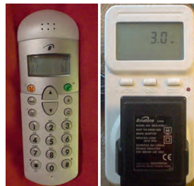
Fot. 11.3. Ten „wampirek” – telefon bezprzewodowy i jego ładowarka – podłączony do prądu zużywa 3 W. To 0,07 kWh/d. Przy cenie 1 kWh na poziomie 50 groszy, to „ciurkanie” prądu będzie rocznie kosztować 13 zł.
