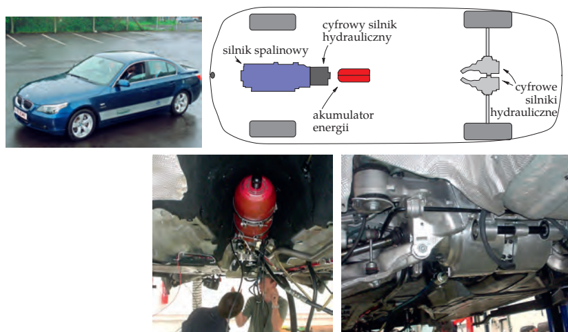
Rys. 20.17. BMW 530i z zainstalowaną przez Artemis Intelligent Power hydrauliką sterowaną elektronicznie. U dołu, po lewej 6-litrowy akumulator (czerwona butla), mieszczący około 0,05 kWh energii w postaci sprężonego azotu. Na dole po prawej dwa 200-kilowatowe silniki hydrauliczne, napędzające tylne koła, służące zarówno do przyspieszania, jak i hamowania. Samochód wciąż jest zasilany standardowym silnikiem benzynowym o mocy 190 kW, ale dzięki sterowanej elektronicznie przekładni hydraulicznej i hamowaniu odzyskowemu, zużywa 30% mniej paliwa.
