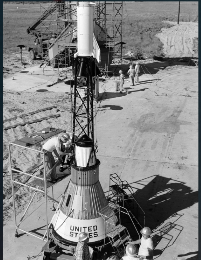
Technicy montują LAS, test LJ-1 (L59-5947)
