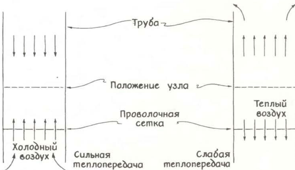
Движения воздуха в трубе осциллятора Рийке.
