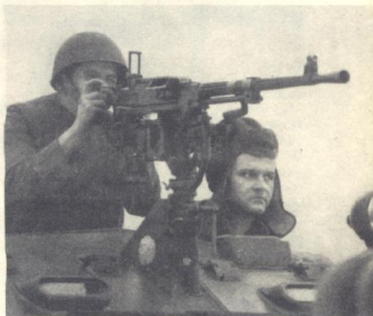
Sposób mocowania karabinu maszynowego SOMB na przedniej płycie kadłuba BRDM
