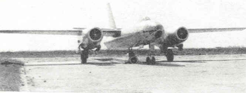
Ił-28 JAKO „LATAJĄCA HAMOWNIA”. UŻYWANA W INSTYTUCIE LOTNICTWA DO BADAŃ PROTOTYPU SILNIKA SO-1
