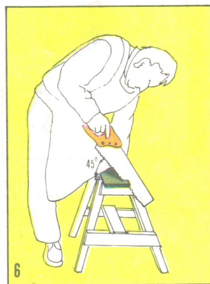
Rys. 6. Cięcie poprzeczne rozpoczyna się kilkoma ruchami piły w kierunku do siebie. Prowadzi się ją pod kątem około 45° do powierzchni materiału
