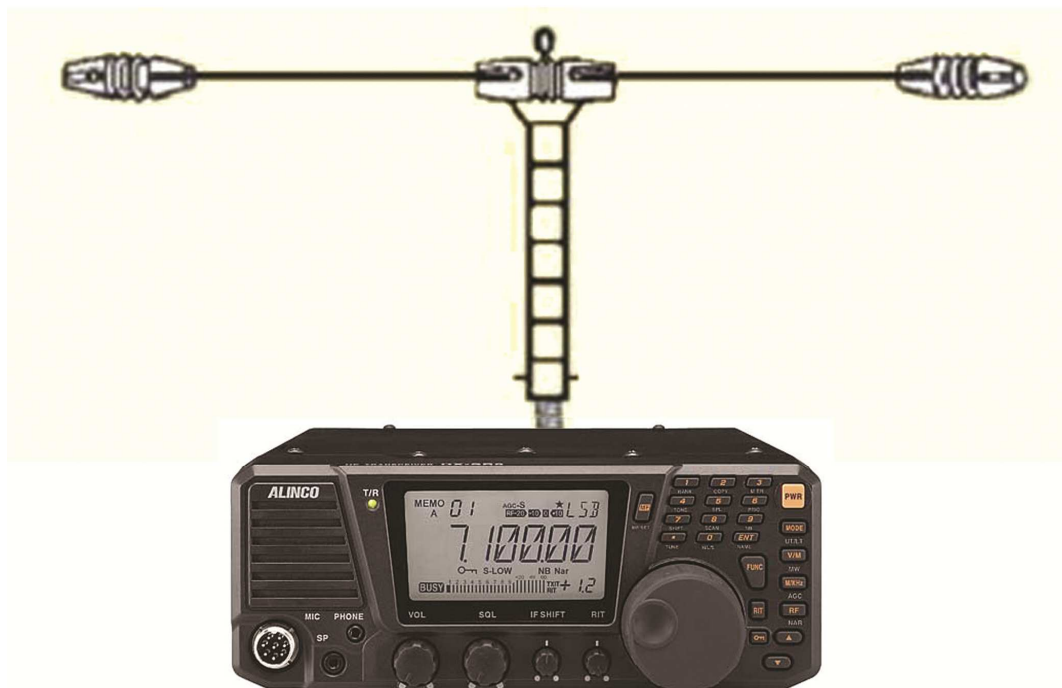
Rys. 1.1. Przykładowe minimalne wyposażenie do pracy na falach krótkich: radiostacja Alinco SR8E z anteną drutową
