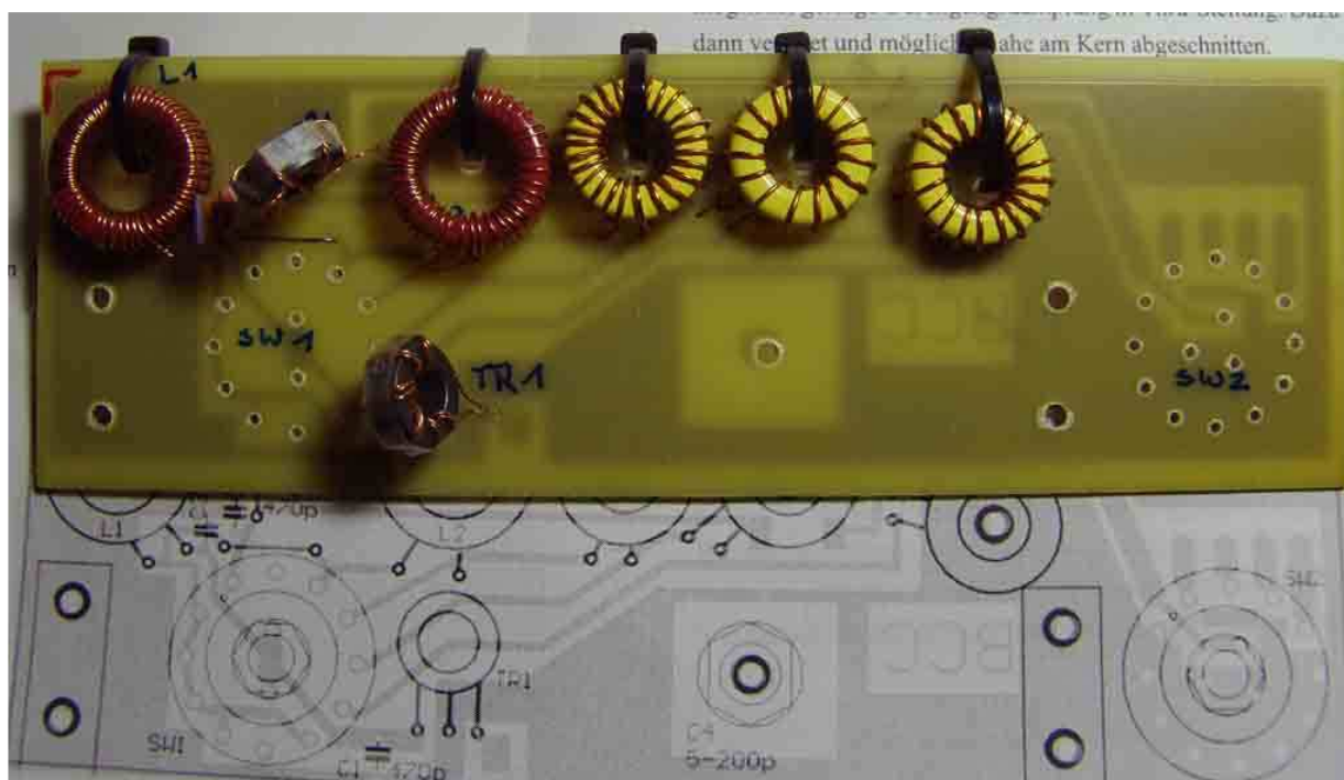
Rys. 15.5. Przykładowa konstrukcja filtra na płytce drukowanej
