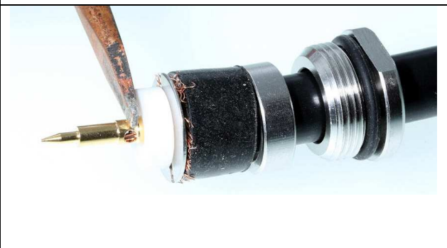
Rys. 6.8d. Lutowanie kontaktu środkowego po założeniu pierwszego izolatora
