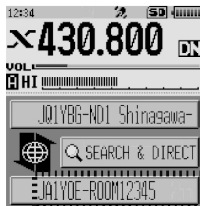
Rys. 14.3. Okno na ekranie FT2DE po odebraniu z przemiennika spisu węzłów WIRES-X
