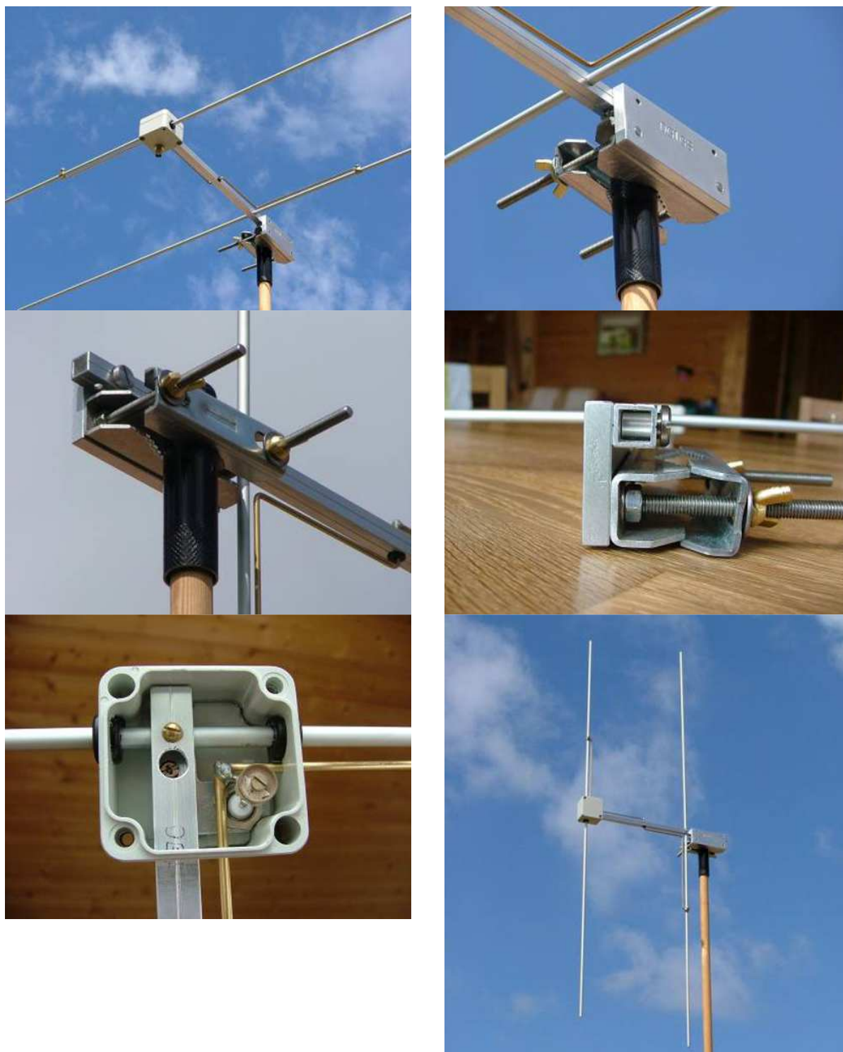
Rys.5.12. Przykład konstrukcji mechanicznej anteny HB9CV na pasmo 2 m w wykonaniu DG1GS
