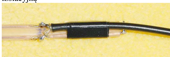
Fot. 18.4. Szczegóły konstrukcyjne anteny wykonanej z kabla 450 Ω przez M0MTJ. Miejsce podłączenia kabla dobrze jest owinać taśmą izolacyjną
