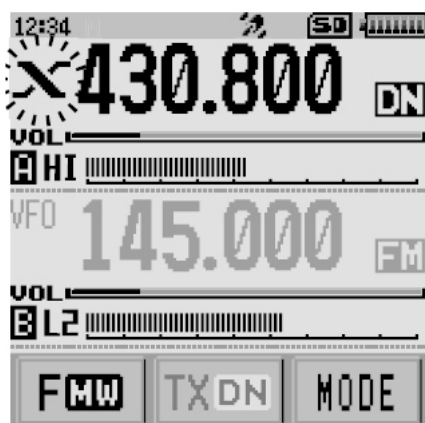
Rys. 14.2. Wyświetlacz FT2DE po naciśnięciu klawisza „X”. W trakcie nawiązywania kontaktu z przemiennikiem litera „X” miga (źródło rys 14.2 – 14.6: instrukcja obsługi)
