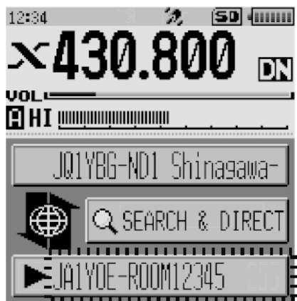
Rys. 4. Widok w trakcie wyboru celu za pomocą gałki strojenia
