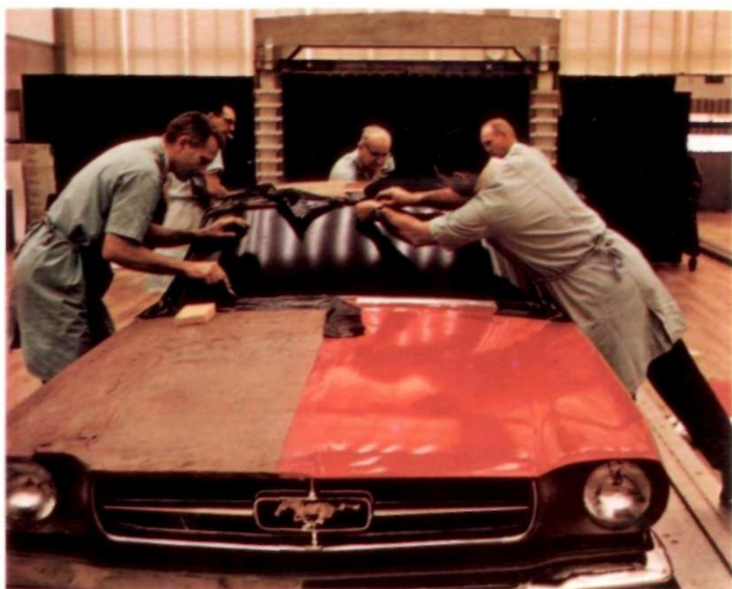
Оформляя глиняный макет, конструкторы воспроизводят переднее ветровое стекло из серой покровной пленки. Перед машины украшен эмблемой, изображающей мустанга, и отделкой из алюминиевой фольги.
