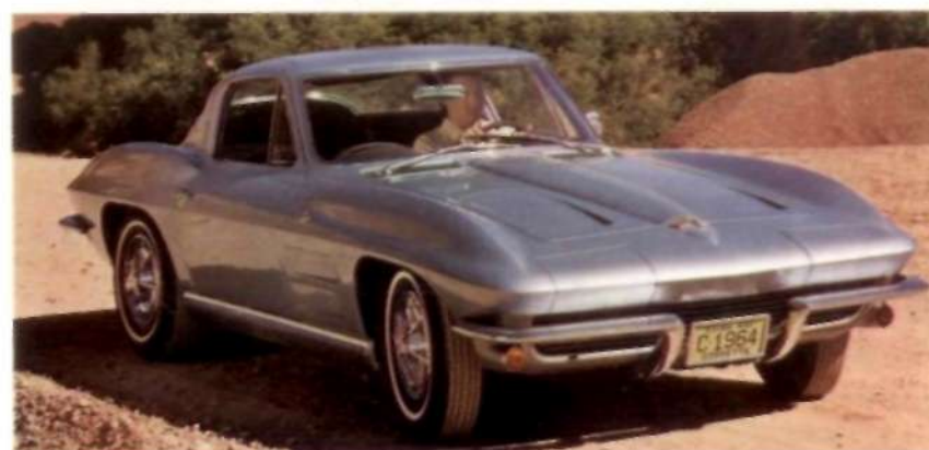
Модели Корветт-стинг-рэй фирмы «Дженерал моторс» имеют V-образные двигатели мощностью от 250 до 375 лошадиных сил и упрочненные стекловолоконные кузова.
