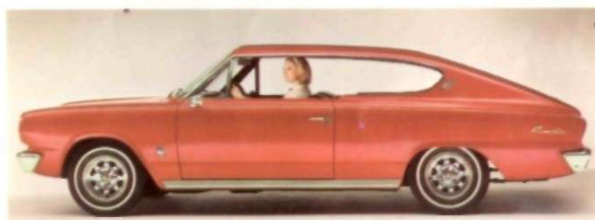
Тарпон фирмы «Американ моторс» снабжен обтекаемым кузовом, изогнутыми ветровым и боковыми стеклами, большим задним окном и скромной хромированной отделкой.
