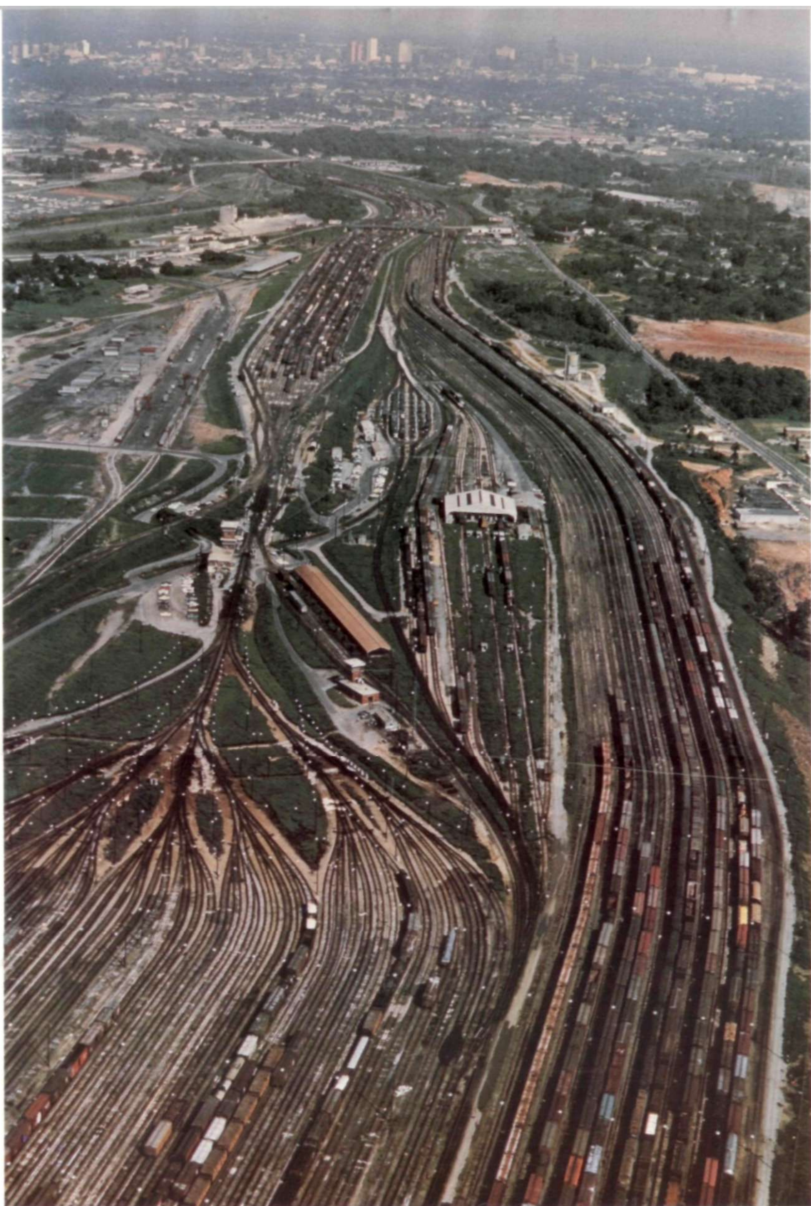
Сортировочная станция в Атланте — один из четырех полностью переоборудованных парков компании — пропускает в день до 3300 товарных вагонов.
