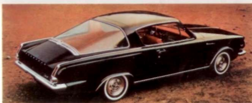
Обтекаемый кузов Барракуды, выпускаемой фирмой «Крайслер», обеспечивает наименьшее сопротивление воздуха на больших скоростях. Заднее сиденье убирается.
