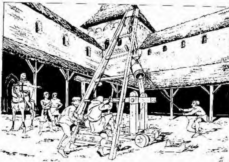
Osadzenie na drewnianym łożu odlanej lufy działa
