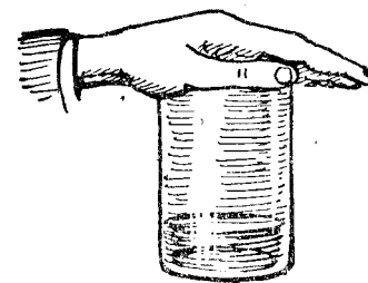
Rys. 20. Szklanka przylgnie do dłoni wskutek zmniejszonego ciśnienia wewnątrz
