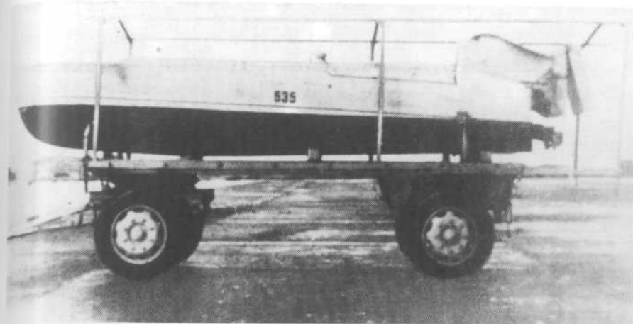
Śruby i „ster” w pozycji transportowej — odchylone poziomo (AUT)
