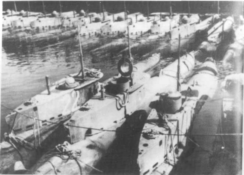
„Seehundy” po kapitulacji Niemiec w 1945 r. Widoczne różnice w konstrukcji kiosków (AUT)
