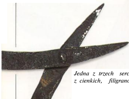
Żelazne nożyce do cięcia blach
