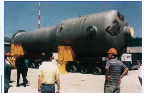
Nowa wytwornica pary New steam generator
