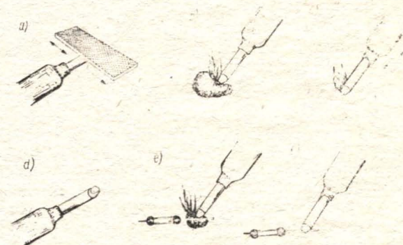
Rys. 51. Czynności przygotowawcze do lutowania połączeń: a) czyszczenie mechaniczne grotu lutownicy, b) czyszczenie chemiczne, c), d) roztapianie i pobieranie lutu cynowego, e) oczyszczanie końcówki rezystora kalafonią, f) pokrywanie końcówki rezystora spoiwem.
