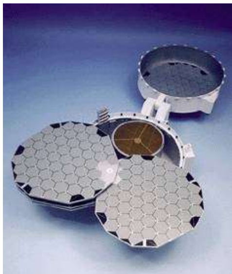
Układ czterech powierzchni, wystawionych na działanie wiatru słonecznego.
