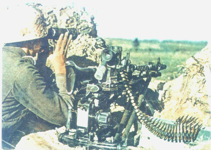
Stanowisko niemieckiego ckm-u MG 34 kal. 7,92 mm z celownikiem optycznym do prowadzenia ognia pośredniego MG-Zieleinrichtung
