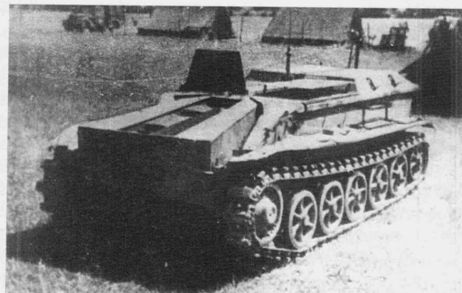
Pojazd "Schwerer Ladungsträger B IV Ausf. A" ze składu 300 dywizjonu pancernego, z przodu widoczna kasetka z 450 kg ładunku wybuchowego
