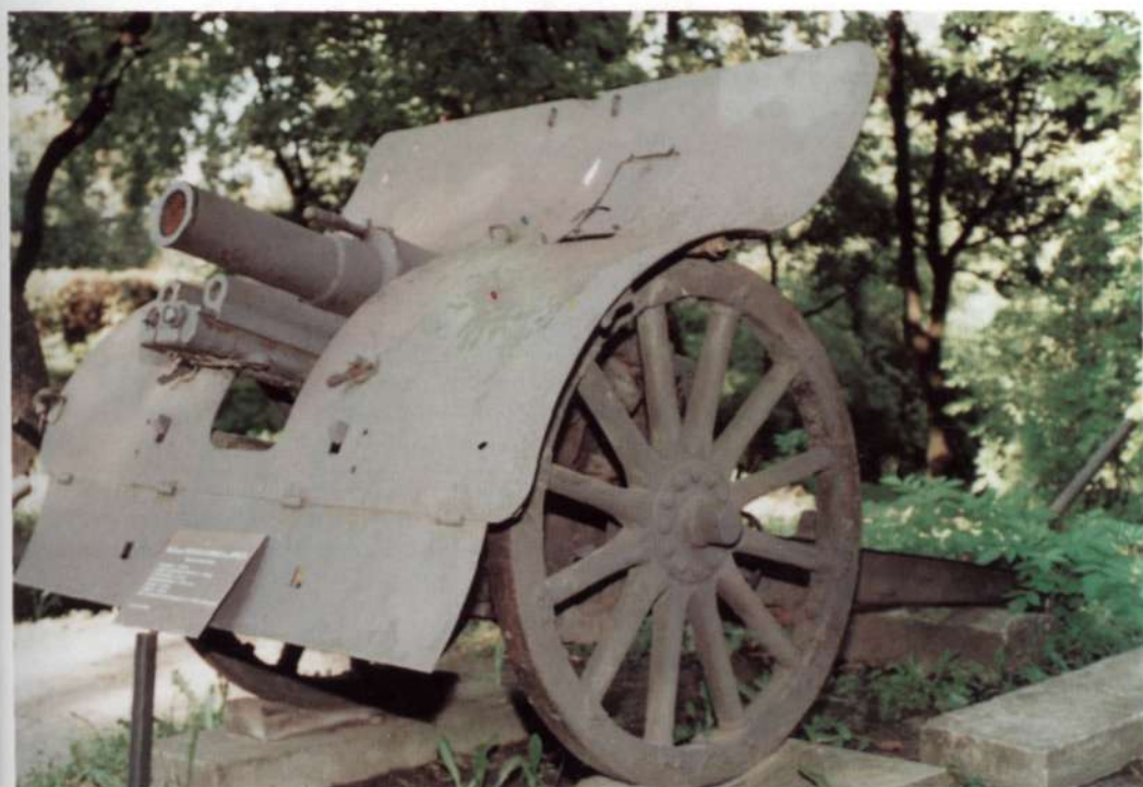
Rosyjska armata góraska kal.76mm wyprodukowana w Obuchowskiej Fabryce Broni. Donośćność - 8000 m. Do transportu armatę rozkładano na kilka części i przewożono na jukach. (eksponat Muzeum Wojska Polskiego w Warszawie)
