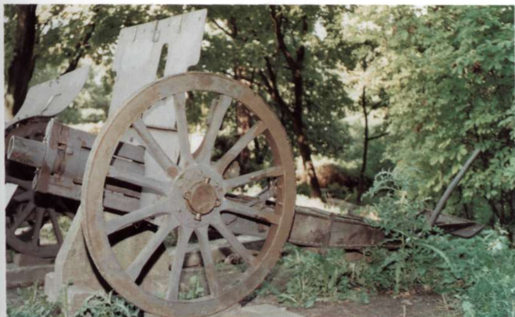
Rosyjska armata góraska kal.76mm wyprodukowana w Obuchowskiej Fabryce Broni. Donośćność - 8000 m. Do transportu armatę rozkładano na kilka części i przewożono na jukach. (eksponat Muzeum Wojska Polskiego w Warszawie)
