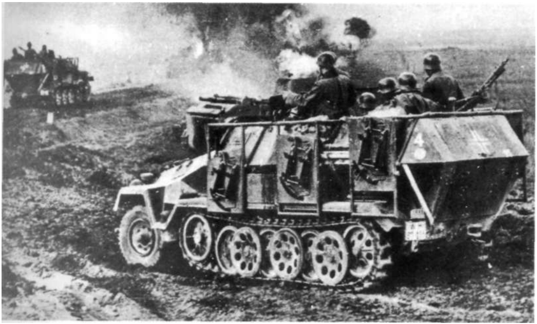
Niemieckie transportery opancerzone SdKfz 251/1 mijające płonący czołg radziecki BT-7. Zwraca uwagę fakt, że transportery wyposażone są w uchwyty do wyrzutni niekierowanych pocisków rakietowych
