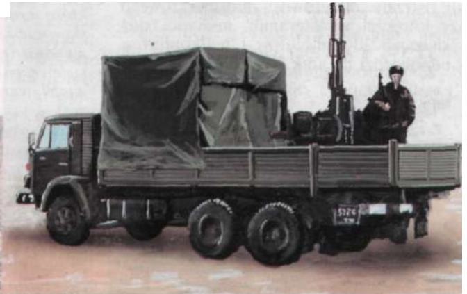
Działa przeciwlotnicze ZU-23/2 zamontowane na ciężarówce Kamaz służyły do ochrony konwojów w górach.
