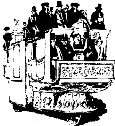
Parowy omnibus dr. Williama Churcha dla 40 podróżnych uważany był za „doskonale zjednoczenie pracy, wiedzy i piękna”. Zastosowany tu został napęd na cztery koła przez oddzielne maszyny parowe. Na podstawie starej ryciny angielskiej.
