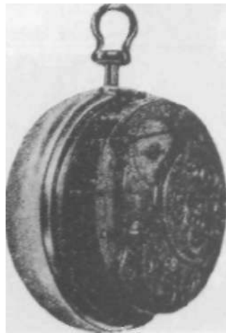
Chronometr Harrisona skonstruowany w 1759 roku - pierwsze w dziejach nauki niezawodne narzędzie wyznaczania długości geograficznej, wg oryginału przechowywanego w Narodowym Muzeum Morskim w Londynie.
