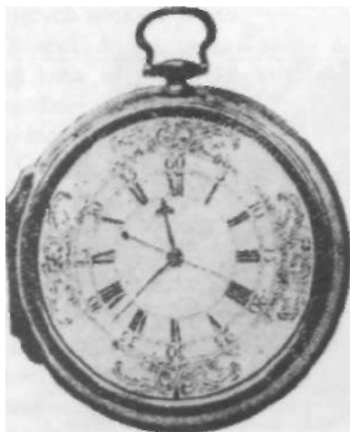
Chronometr Harrisona skonstruowany w 1759 roku - pierwsze w dziejach nauki niezawodne narzędzie wyznaczania długości geograficznej, wg oryginału przechowywanego w Narodowym Muzeum Morskim w Londynie.
