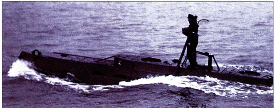
Miniaturowe okręty podwodne klasy „X” miały – teoretycznie – zasięg 2776 km, jednak w pobliżu akcji holowano je za pomocą konwencjonalnych okrętów podwodnych. Tak długa podróż w ciasnych kadłubach „łupinek” miałaby fatalny wpływ na kondycję ich załóg.
