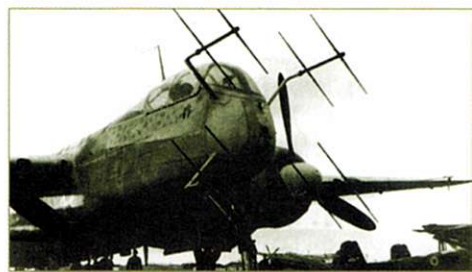
Heinkel He 219A-7 z silnikami serii G, wyposażony w radar FuG 220d z elementami urządzenia Streuwelle. Do jednostek frontowych (I/NJG 1) dotarła tylko jedna tak wyposażona maszyna.
