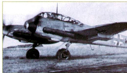
Me 410A-1 (numer seryjny 10 185, oznaczenie kodowe U5+KG) ze Stab V/KG 2 z tłumikami płomieni założonymi na rury wydechowe. Urządzenia te montowano w myśliwcach nocnych.
