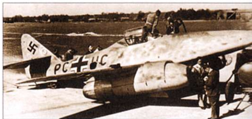
Trzeci prototyp samolotu Me 262, który jako pierwszy dokonał samodzielnego lotu z napędem odrzutowym.
