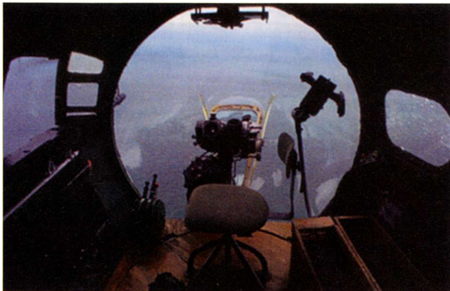
Widok z przedniego stanowiska strzeleckiego „latającej fortecy”, mieszczącego się w przeskłonej kapsule na samym przodzie kadłuba samolotu.
