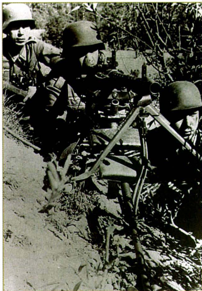
Karabin maszynowy MG 34 zamontowany na podstawie trójnożnej Lafette 34 był zdolny do prowadzenia długotrwałego ognia zaporowego i osłonowego w czasie ataków piechoty.
