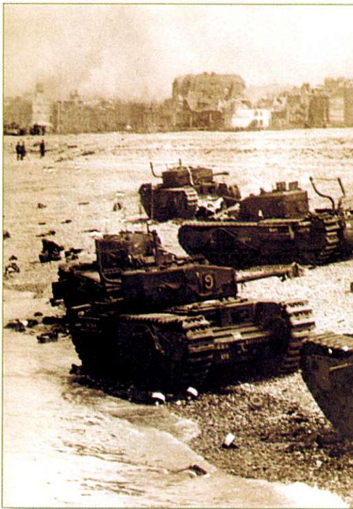
Plaża w Dieppe, porzucone kanadyjskie czołgi Churchill. Większość pojazdów została unieruchomiona na kamienistej plaży wskutek awarii układu jezdnego.
