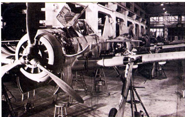
Focke-Wulf Fw 190A-1 na linii montażowej zakładów w Bremie, 1941 r. Wyraźnie widoczny jest szeroki rozstaw kół podwozia i liczne klapy inspekcyjne, pozwalające na obsługę silnika gwiazdowego BMW 801. Samoloty tego typu stanowiły sporą część niemieckich sił lotniczych, które wzięły udział w walkach nad Dieppe w sierpniu 1942 r.
