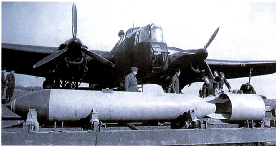
Whitley Mk V z przygotowaną do załadunku ciężką 2000-funtową (907 kg) bombą przeciwpancerną. Whitley Mk V mógł przenosić ponad 3000 kg bomb, o wiele więcej niż dwa pozostałe ciężkie bombowce brytyjskie tego okresu, Hampden i Wellington.
