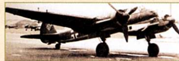
Junkers Ju 88C-6b, pierwsza nocna wersja myśliwska tego samolotu wyposażona w radar.
