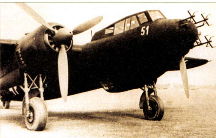
Dornier Do 217J był przekonstruowaną i dostosowaną do nocnego zwalczania bombowców wersją samolotu Do 217E. Na zdjęciu samolot Dornier Do 217J-2, różniący się od wersji J-1 wyposażeniem w radar i usunięciem komory bombowej.
