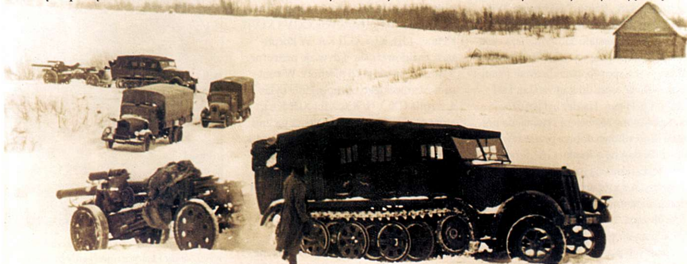
W ciężkich warunkach rosyjskiej zimy niemieckie pojazdy gąsienicowe zdały egzamin. Problemem był brak odpowiedniej jakości smarów oraz paliwa. Pierwsza partia smarów przystosowanych do eksploatacji w temperaturze -20^{\circ}\text{C} dotarła do jednostek frontowych dopiero na początku grudnia.
