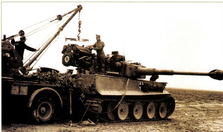
Wymiana silnika w czołgu ciężkim PzKpfw VI Ausf. H1 Tiger z 1. kompanii 501. batalionu czołgów ciężkich. Czołg tego typu, jaki Brytyjczycy zdobyli w kwietniu 1943 r., został poddany gruntownym próbom w Bovington.
