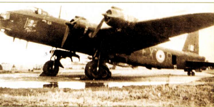
Short Stirling Mk III ze 199. dywizjonu (litera kodowa R, numer ewidencyjny LJ525) o nazwie własnej „Jolly Roger”. W spodzie kadłuba widoczne anteny systemu zakłócającego „Mandrel”.
