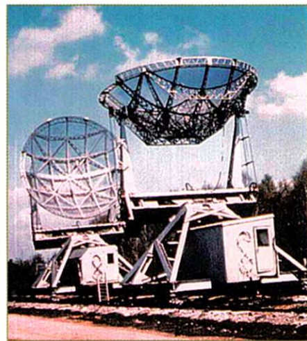
Dwie stacje radarowe Würzburg, będące częścią niemieckiego łańcucha obronnego. Stacje na zdjęciu pracowały w rejonie francuskiego miasta Nancy.
