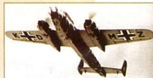
Dornier Do 217J KD+MZ wykorzystywany do prób lotniczych – maszyna posiada komorę bombową wersji J-1, ale jej wyposażenie radarowe to FuG 202 z wersji J-2. Operacyjne samoloty tej wersji były malowane na czarno.
