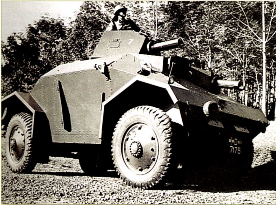
Samochód pancerny Alvis Straussler, zdjęcie wykonane przed wybuchem walk. Pojazd był uzbrojony w karabin maszynowy Colt-Browning kaliber 12,7 mm w obrotowej wieżyczce i karabin Vickers 6,5 mm w kadłubie.
