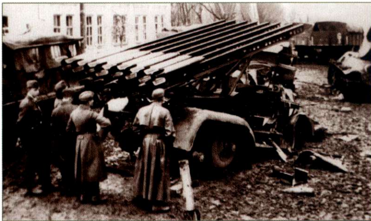
Grupa niemieckich żołnierzy ogląda wcześniej nieznaną broń – radziecką wyrzutnię raketową BM-13 zamontowaną na podwoziu samochodu ZiS 5.
