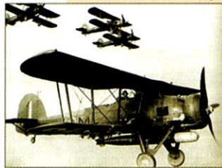
Samoloty Swordfish Mk I przenoszące pod kadłubem standardowe torpedy o wadze 730 kg.
