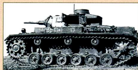
PzKpfw III, na zdjęciu wersja G, miał doskonałe zawieszenie na drążkach skrętnych zapewniające wysoki komfort jazdy.
