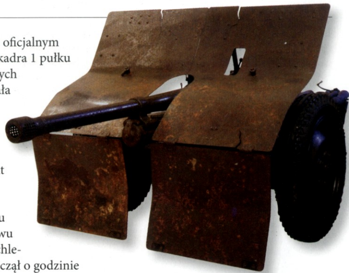
Polska armata przeciwpancerna wz. 36 Bofors 37 mm. We wrześniu 1939 r. była to niezwykle skuteczna broń przeciwko czołgom. Lekka, ważąca jedynie 380 kg armata, przebijała pancerz o grubości 40 mm z odległości 100 metrów.
