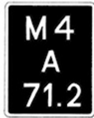
Znak wskazujący pikietaż drogi
