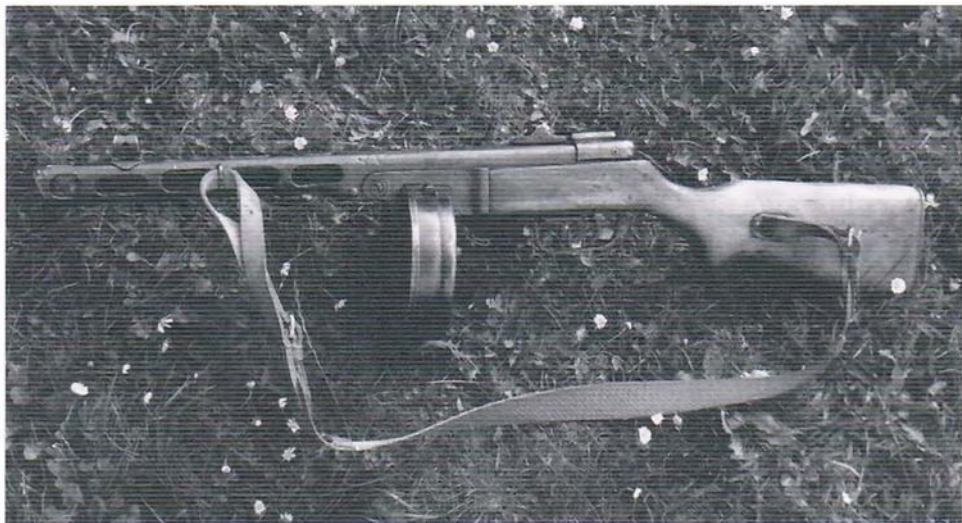
RADZIECKI PISTOLET MASZYNOWY PPSZ WZ. 1941 Z MAGAZYNKIEM BĘBNOWYM, POPULARNIE ZWANY PEPEŚĄ (ZBIORY MUZEUM CZYNU ZBROJNEGO W LIPCACH REYMONTOWSKICH)
