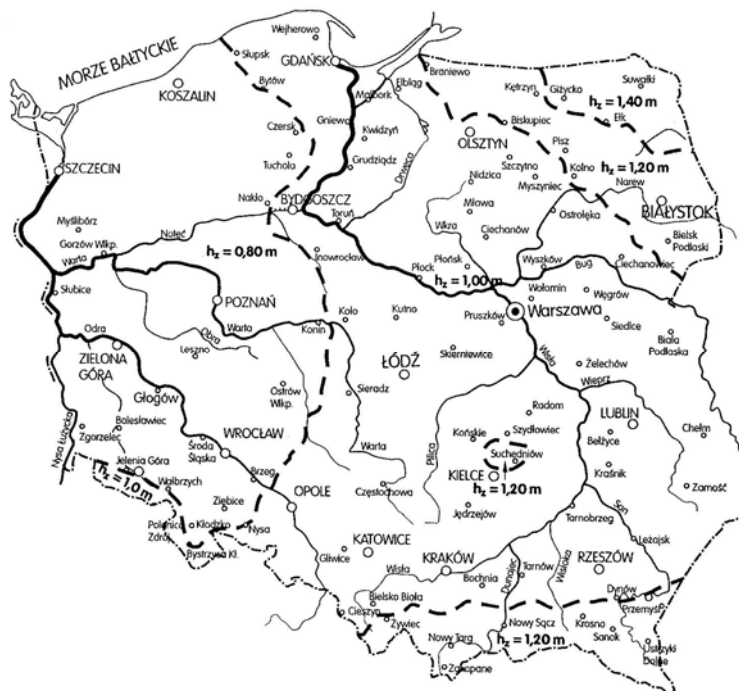
Rys. 24. Głębokość przemarzania gruntów przyjmowana do celów fundamentowania w różnych strefach kraju [13, s. 58]
