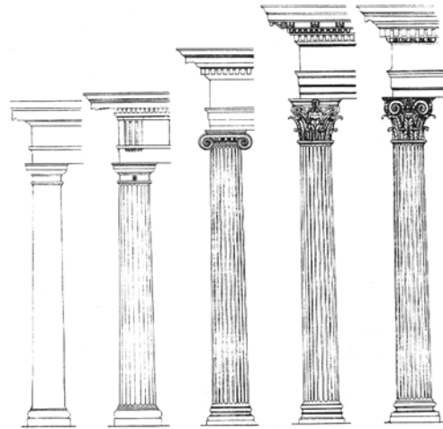
Rys. 25. Porządki architektoniczne stosowane w starożytnym Rzymie: tokański, rzymsko-dorycki, rzymsko-joński, rzymsko-koryncki, kompozytowy [2, s. 37]
