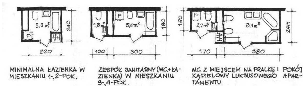
Rys. 16. Przykładowe rozwiązania łazienki i wc. [13, s. 101]
