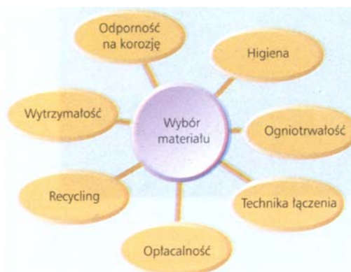
Rys. 2. Istotne kryteria wyboru materiału [10, s. 6]
