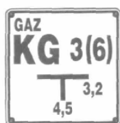
Rys. 38. Oznaczenie kurka głównego (w budynku jest sześć kurków głównych, a zlokalizowany jest trzeci) [7, s. 76]
