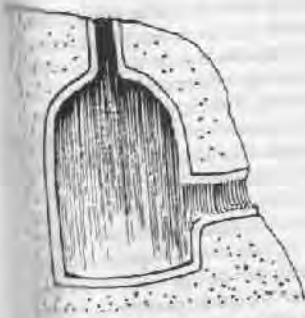
W skraj stoku wciska się drąg. Z boku wykopuje się dziurę wciągającą drąg i wydrąży się stożkoła niego jamę w kształcie ula. Na koniec wyciąga się drąg, a jamę wylepia się mokrą gliną.
