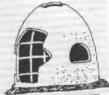
Podobny piec wolnostojący. Rusztowanie z gałęzi i gałązek należy z zewnątrz i od środka obkleić mokrą gliną. Już pierwszy żar wypali glinę, tworząc z niej twardą ścianę.
